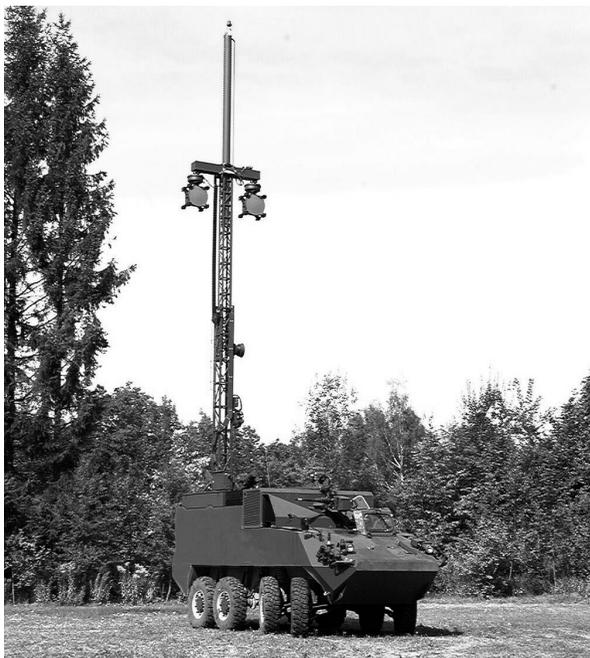
Blindato ruotato IMP con pilone integrato, antenne e apparecchi a fasci hertziani montati stabilmente
