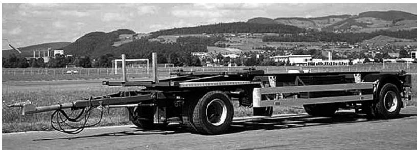
Les remorques constituent avec celles déjà introduites dans le cadre du programme d'armement de 1999 une famille de remorques à deux essieux à suspension pneumatique. Elles permettent de charger et de décharger des bennes amovibles sur béquilles sans avoir recours à des moyens auxiliaires. Des traîneaux permettent de charger la benne amovible ou les conteneurs à partir du sol et de les déposer à nouveau au sol.
