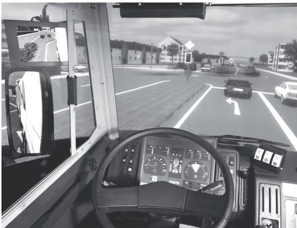
Flexible Fahrzeugnachbildung durch einen Monitor als Instrumententafel
